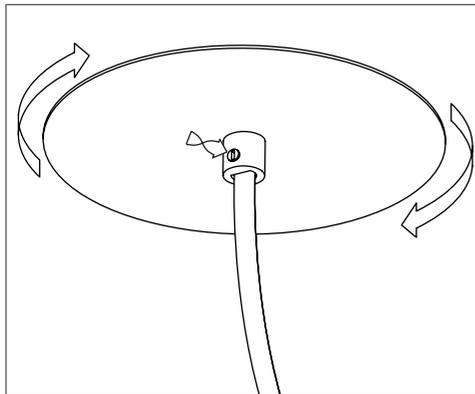
Drehen Sie den Baldachin im Uhrzeigersinn bis dieser einrastet und fest sitzt. Danach sichern Sie das Kabel mit der Zugentlastung indem Sie die Madenschraube wieder hineindrehen.
