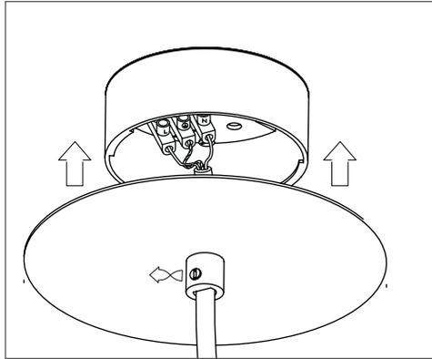
Nach Anschluss der Leitung verstauen Sie die Klemme in der Aufputzdose, sodass diese nicht mehr heraussteht.
