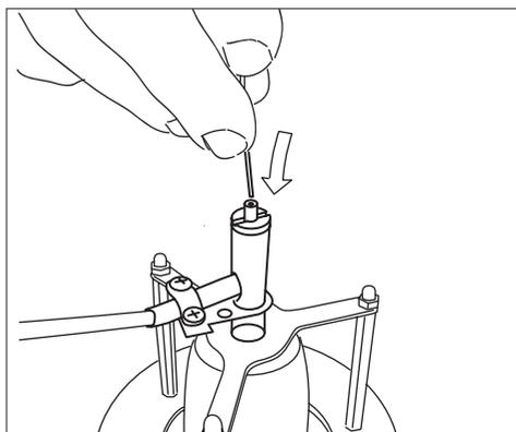
Ziehen Sie das Drahtseil soweit heraus, bis die Leuchte in gewünschter Höhe hängt. Durch Drücken des kleinen Rohres am Drahtseilhalter kann das Seil bei Bedarf wieder gelöst werden.
