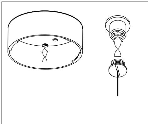
Befestigen Sie den Drahtseilhalter im näheren Umkreis des Deckenauslasses an der gewünschten Stelle. Verwenden Sie dazu adäquates Befestigungsmaterial entsprechend Ihrer Decke.
